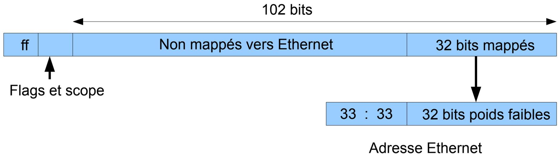
La machine faisant partie d'un groupe multicast programme son interface pour être "à l'écoute" sur l'adresse MAC ainsi obtenue à partir de l'ad groupe.
