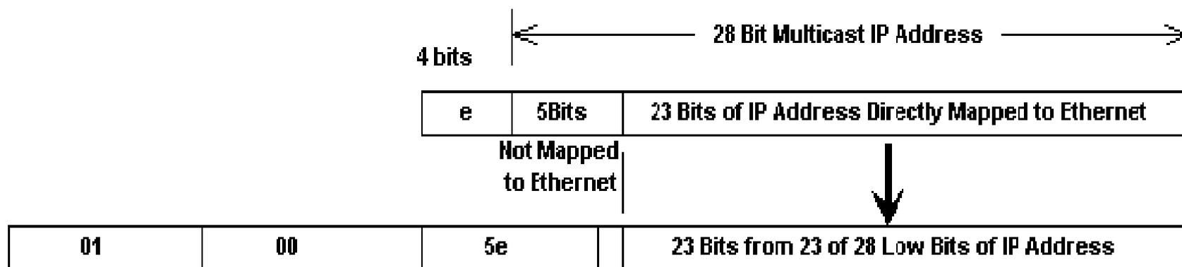
La machine faisant partie d'un groupe multicast programme son interface pour être "à l'écoute" sur l'adresse MAC ainsi obtenue à partir de l'ad groupe.
